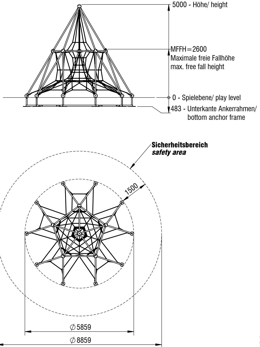
**Maximale freie Fallhöhe / max. free fall height:** 2,6 m
