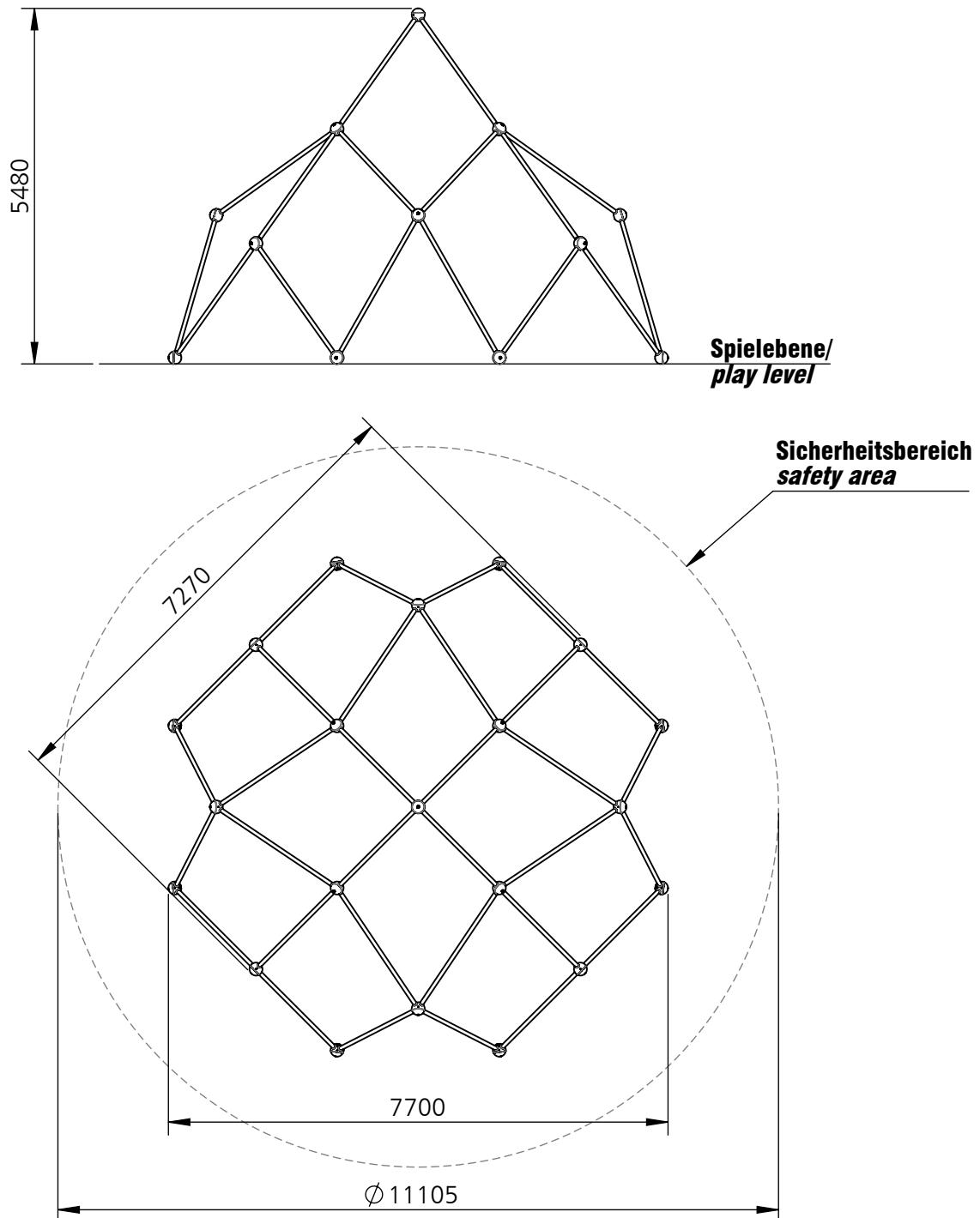
**Maximale freie Fallhöhe / max. free fall height:** 2,39 m
